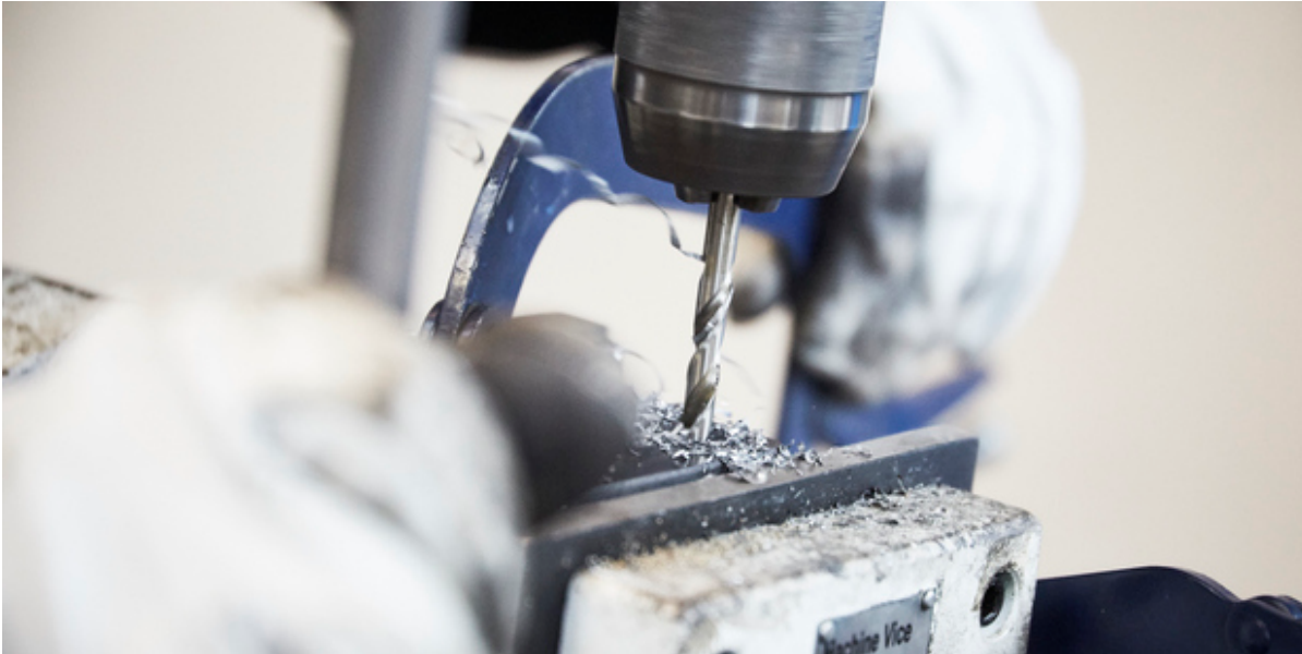
Boremaskine borer i metal. Foto: Frederikssund Kommune.
