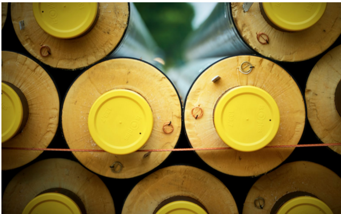
En stak fjernvarmerør.
