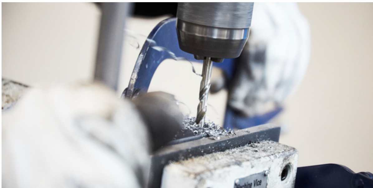
Boremaskine borer i metal. Foto: Frederikssund Kommune.
