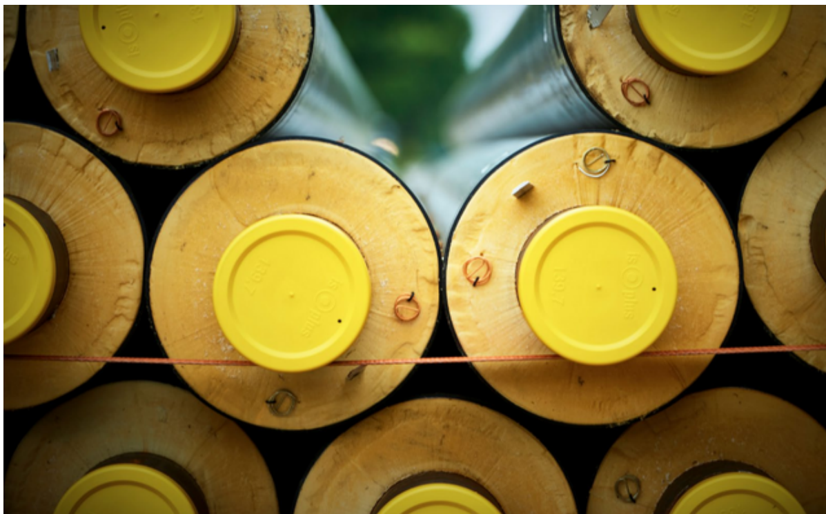
En stak fjernvarmerør.
