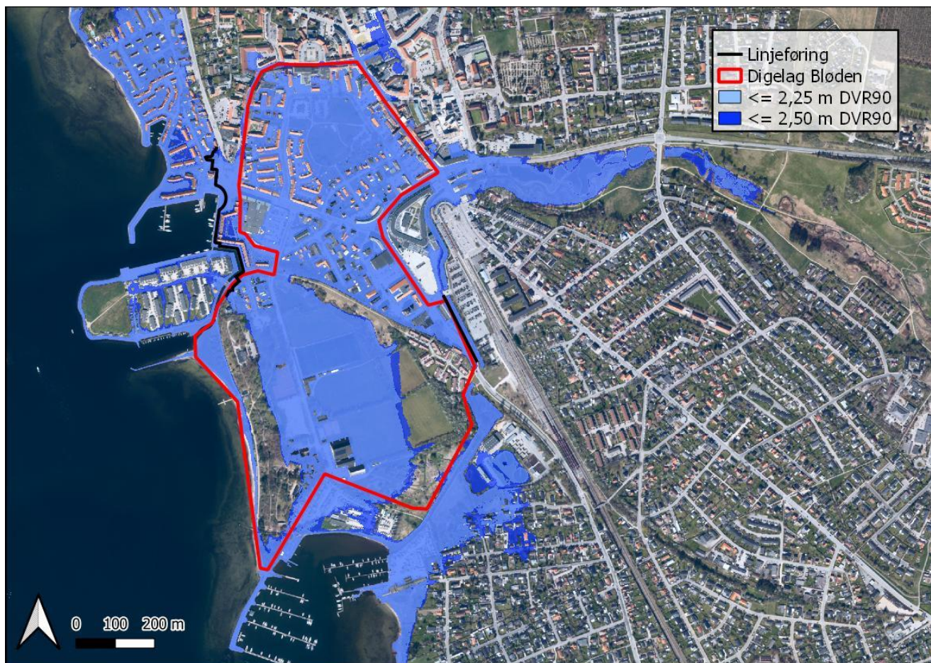
Figur 2.1: Oversigt over digelaget Blødens område og maksimal oversvømmelsesudbredelse ved en vandstand på +2,25 m og +2,50 m. De sorte linjer markerer, hvor der skal anlægges kystbeskyttelse for at beskytte digelaget blødens område. Ortofoto: 2022. Oversvømmelsesudbredelse er hentet fra scalgo.com/live .
