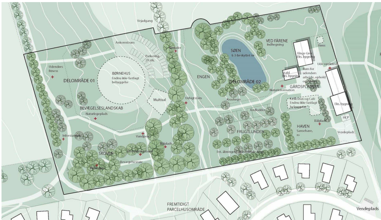
Figur 6: Illustrationsskitse – eksempel på fremtidig disponering af bebyggelse, opholdsarealer, fællesfunktioner, stinet, parkering mv. i planområdet (Arkitema/COWI).
