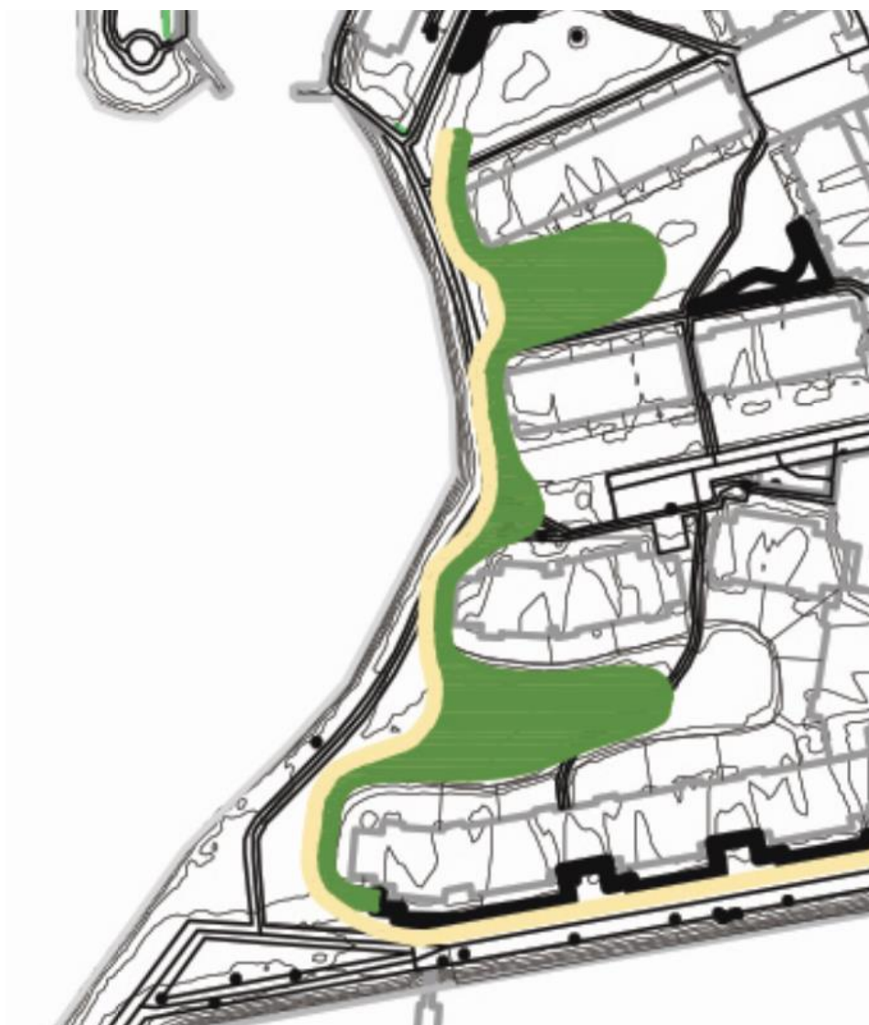
Figur 4.15: Plantegning af diget i den sydlige del af Delområde 2. Digets udbredelse er vist med grøn.
