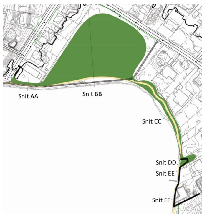
Figur 4.2: Plantegning af højvandsbeskyttelsen i Delområde 1. Højvandsbeskyttelsens omtrentlige udbredelse er vist med grøn. Placering af Snit AA, BB, CC, DD, EE og FF er markeret med sort linje.
