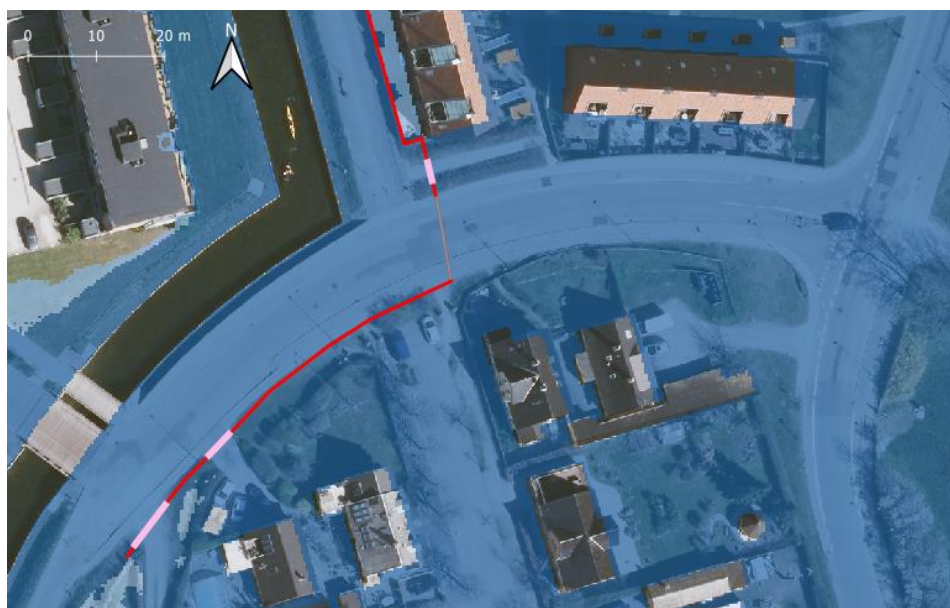
Figur 4.22: Oversigtskort over højvands-skot løsningen på Stenværksvej.
