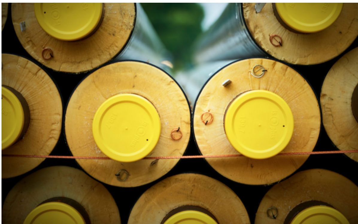
En stak fjernvarmerør.
