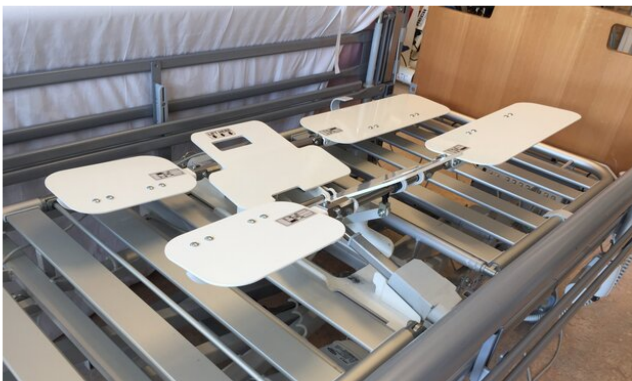
Mekanikken i bunden af den intelligente sengebund.
