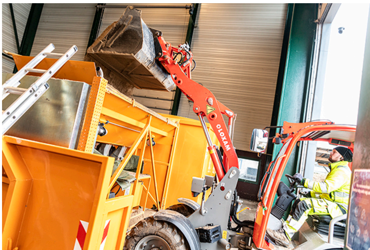
Minilæsser fylder sand i maskinen til at fylde sandsække.
