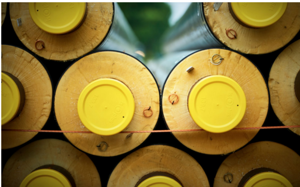
En stak fjernvarmerør.
