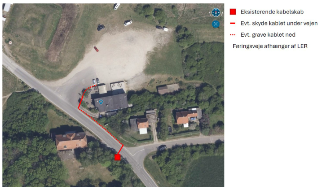
Figur 3 Forventet placering af elkabel
