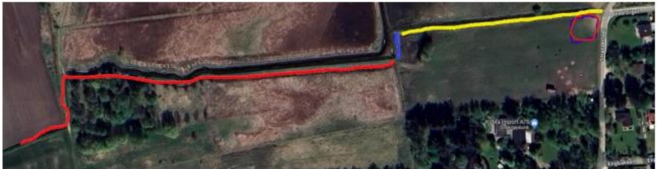
Figur 1: Oversigt over digets placering, hvor topkoten hæves til 2,25 DVR90. Ved det gule og blå område, godkendes en udvidelse af digets fod med 80 cm på landværts side.
