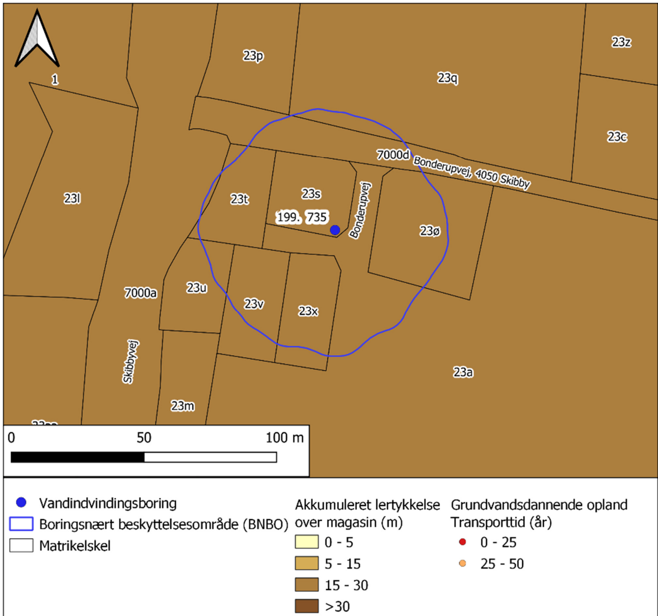
Figur 3-3 Akkumuleret tykkelse af ler over grundvandsmagasinet samt grundvandsdannende opland vist som farvede prikker tematiseret ud fra transporttiden fra grundvandsspejl til boring
