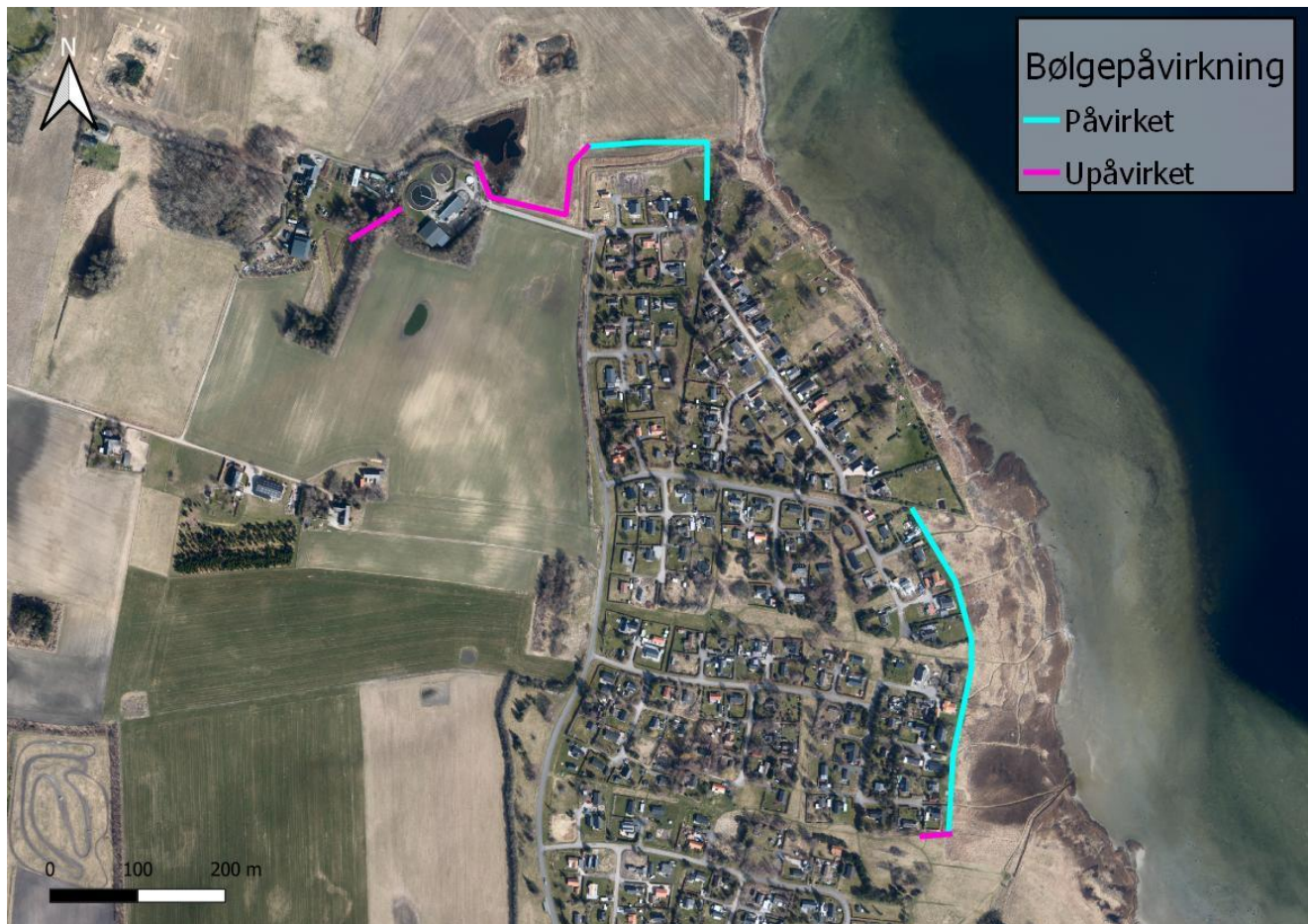
Figur 3.6: Oversigt over hvilke strækninger der er bølgepåvirket og hvilke strækninger der er upåvirket. Ortofoto: 2021.
