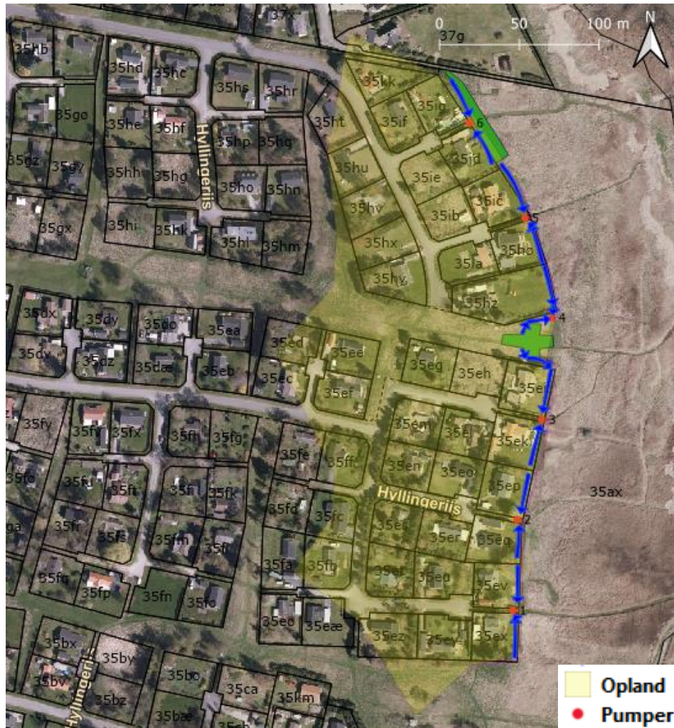
Figur 3.7: Placering af pumper og strømningsretning i lavninger (blå pile, retning på pil viser strømningsvej) bag dige og højvandsmur i øst.
