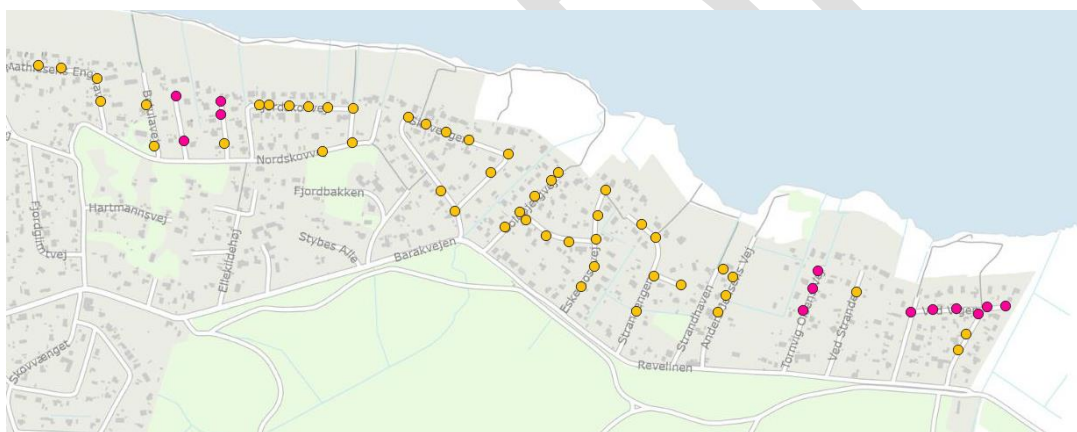
Figur 13 - tekniske installationer der oversvømmes ved en 100 års hændelse i 2050 med en vandstand på 2,02m DVR90. de røde punkter angiver elbokse der i dag er hævet for at sikre dem imod oversvømmelse. Kilde: Frederikssund Kommune registrering november 2022.
