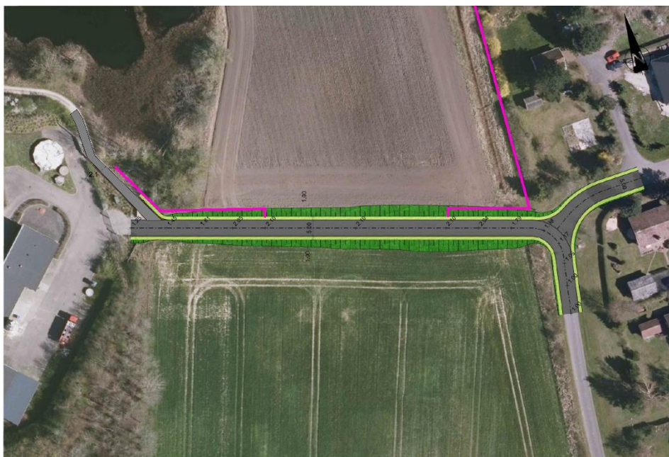
Figur 6.3: Hævning af vejen til renseanlægget samt grusvejen nordom renseanlægget.
