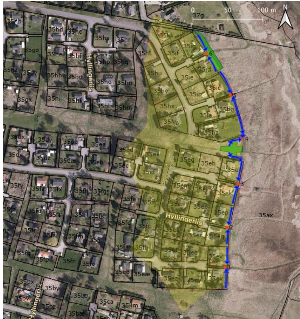
Figur 7.1: Placering af pumper og strømningsretning i grøfteanlæg bag dige og højvandsmur i øst.
