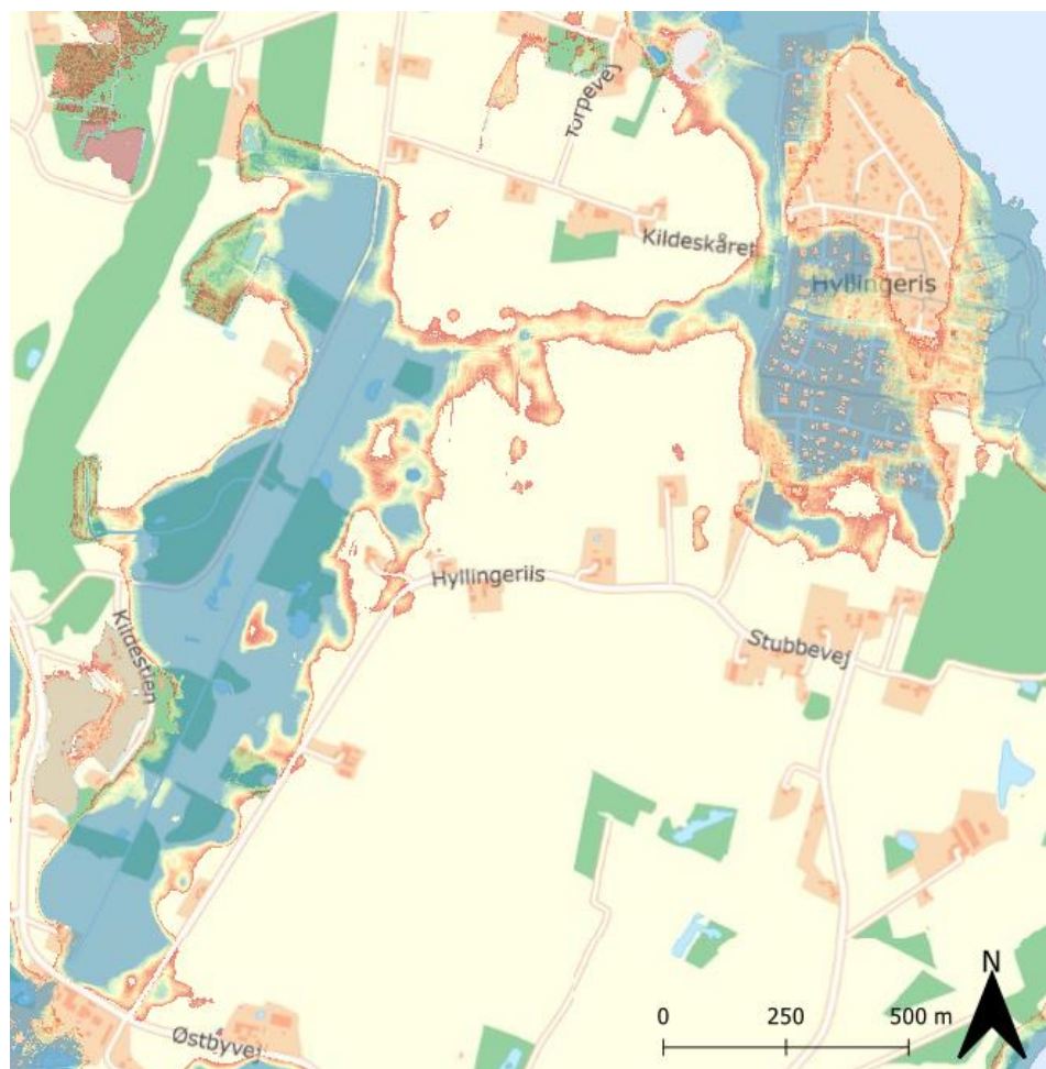
Figur 2.2: Terrænoverflade fra Hyllingeris til Østbyvej med højder i meter over dagligt vande (DVR90).
