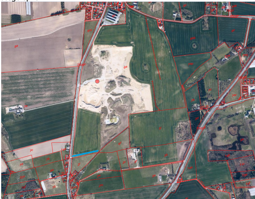
Figur 1 luftfoto af ejendommen, hvor støjskærmen skal etableres. Den blå streg viser den omtrentlige placering af støjskærmen.
