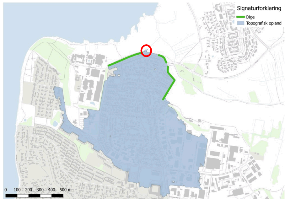
Figur 4.11 Det topografiske opland til det nye dige langs Linderupvej, dige markeret med grøn, udløb markeret med rød cirkel.
