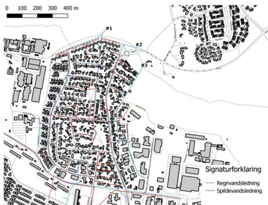
Figur 2.8 Udsnit af Frederikssund Forsynings ledningsplan. Blå ledninger er regnvandsledninger, røde ledninger er spildevandsledninger. De tre udløb til Græse Å er markeret med #.
