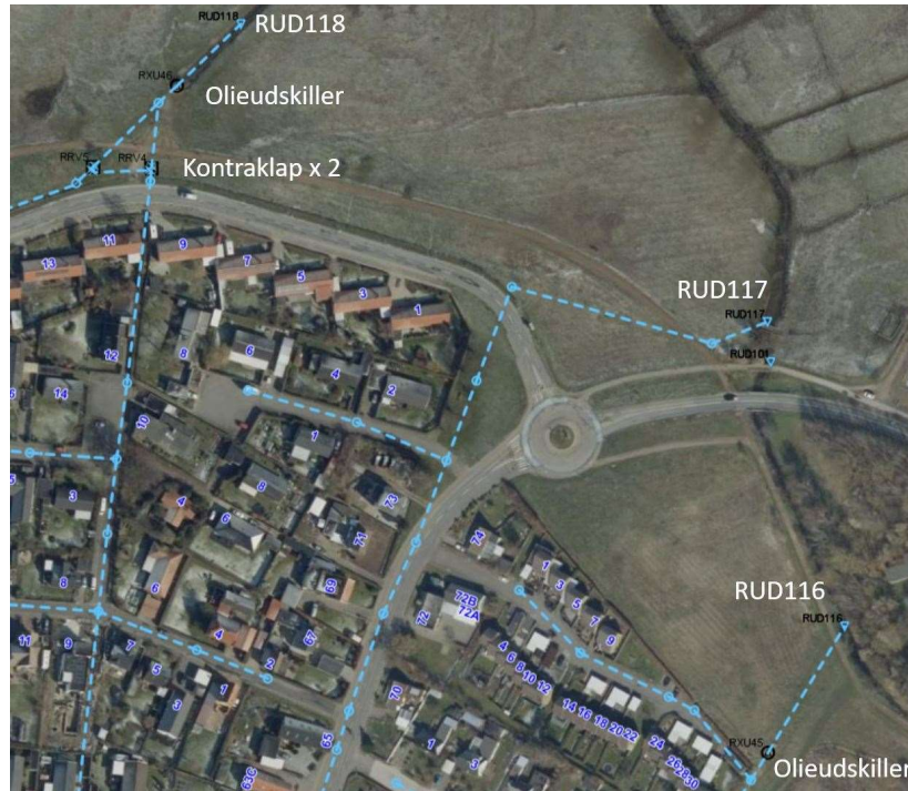
Figur 2.7: Udsnit af Novafos ledningsplan for regnvand. Blå ledninger er regnvandsledninger med indikation af udløbspunkt i Græse Å med ID-nr. RUD118, RUD117 og RUD116 (hvor RUD står for Regnvands-UDløb). Der er kun etableret kontraklapper i de to nordlige brønde med udløbsbygværk RUD118 ved Linderupvej 9-11. Kilde: Frederikssundkort https://webkort.frederikssund.dk/spatialmap
