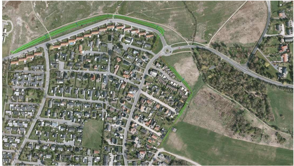
Figur 5.1: Højvandsbeskyttelsen i Frederikssund Nord hindrer havvand i at trænge ind og samtidig er der indlagt rørgennemføringer ved naturlige skybruds-passager (blå rør). Hvor der er større stier og gennemgange nu, vil der være passage for gående og cyklister henover diget.
