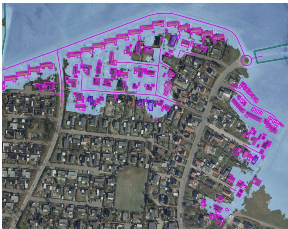
Figur 7.1: Skadesberegning- værktøjet KAMP fra www.klima-tilpasning.dk viser, at der er potentielt 185 bygninger fordelt over 89 matrikler, som bliver oversvømmet, hvis ydre vandstand er lig med sikringshøjden på de 2,5 m DVR90. Den samlede vurderede skade ved havoversvømmelse af området er beregnet til 76 mio. kr. i KAMP-værktøjet, se https://kamp.miljoportal.dk/
