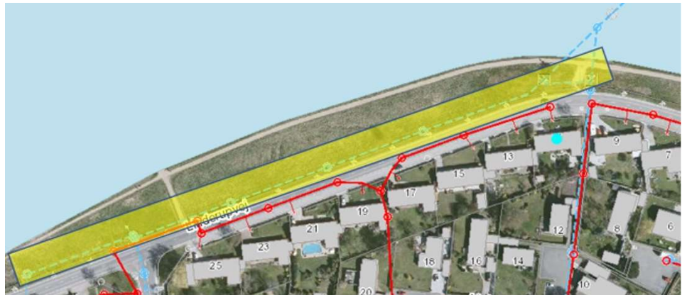
Figur 2.10: NOVAFOS ejer de regnvandsafledninger, der afvander baglandet og løber umiddelbart nord for og parallelt med Linderupvej - disse er nu strømpeforet. Illustration: NOVAFOS A/S
