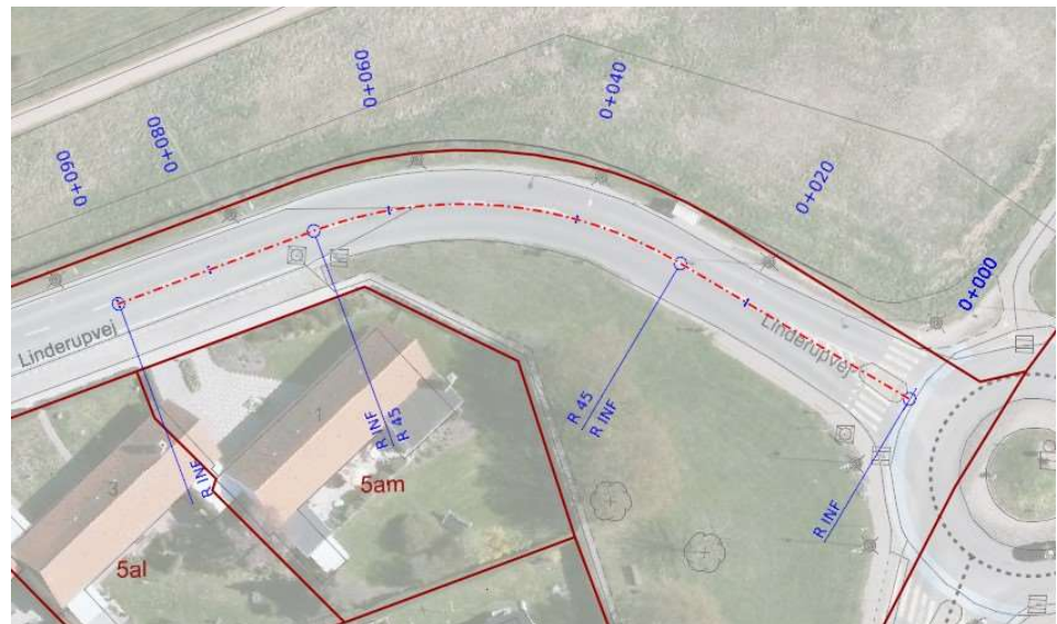
Figur 6.8: Linderupvejens vejplan for vejhævningsudstrækning. Den røde stiplede linje angiver vejens centerlinje, mens de brune linjer angiver matrikelskel. Bemærk lokale stationeringslinjer (blå).
