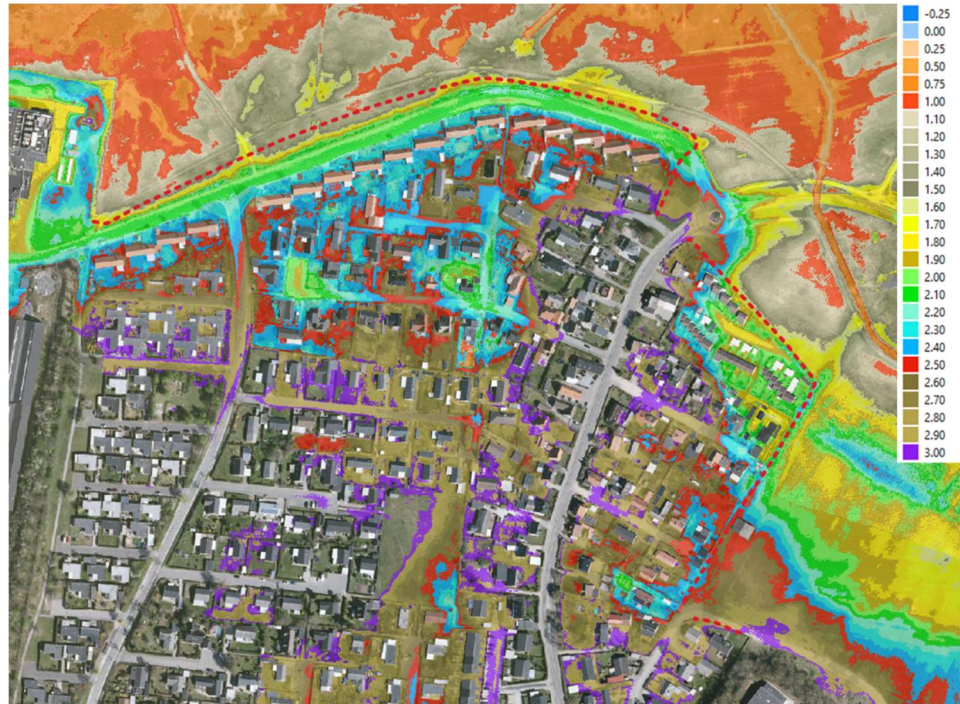
Figur 2.2: Terrænoverflade med højder i meter over dagligt vande (DVR90), hvor højvandsbeskyttelsen er vurderet til at blive placeret fra Haldor Topsøe i vest til Ellehammervej i sydøst ved stiplede rød linje.
