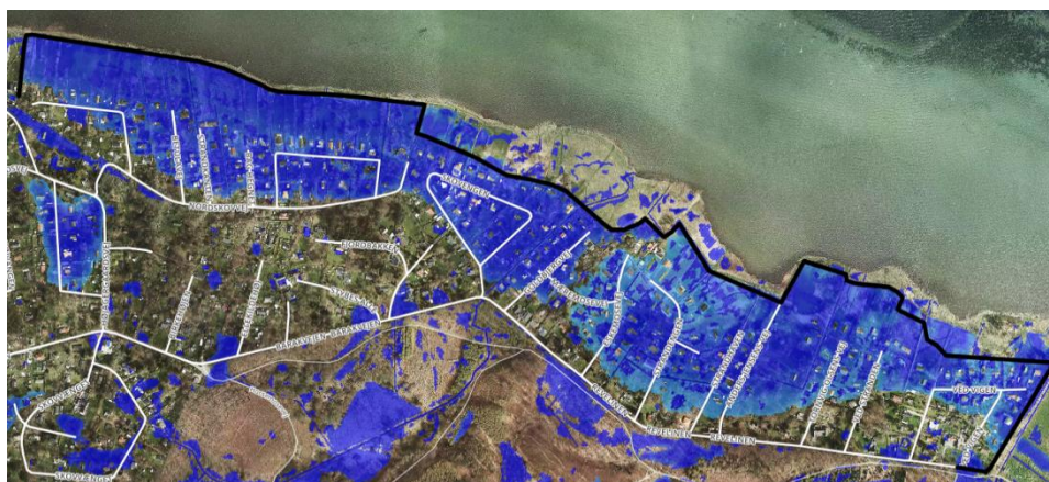
Figur 4-6 Overfladevand fanget på indersiden af diget uden afledning via sluser og/eller pumper.
