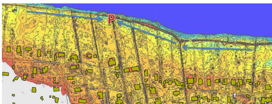
Figur 4-8 Koter og foreslået placering af pumpe og grøfter i den vestlige del af projektområdet.
