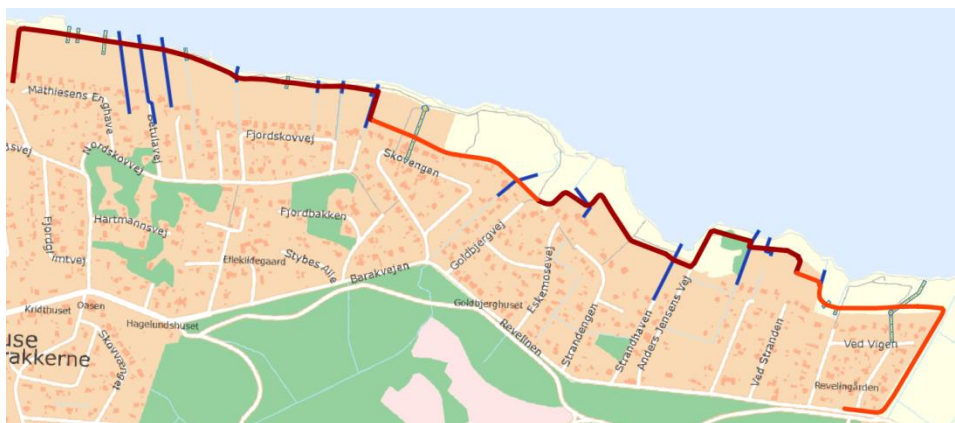
Figur 4-7 Det nye dige med eksisterende grøfter/dræn (gulgrønne) og grøfter/vandløb (blå).
