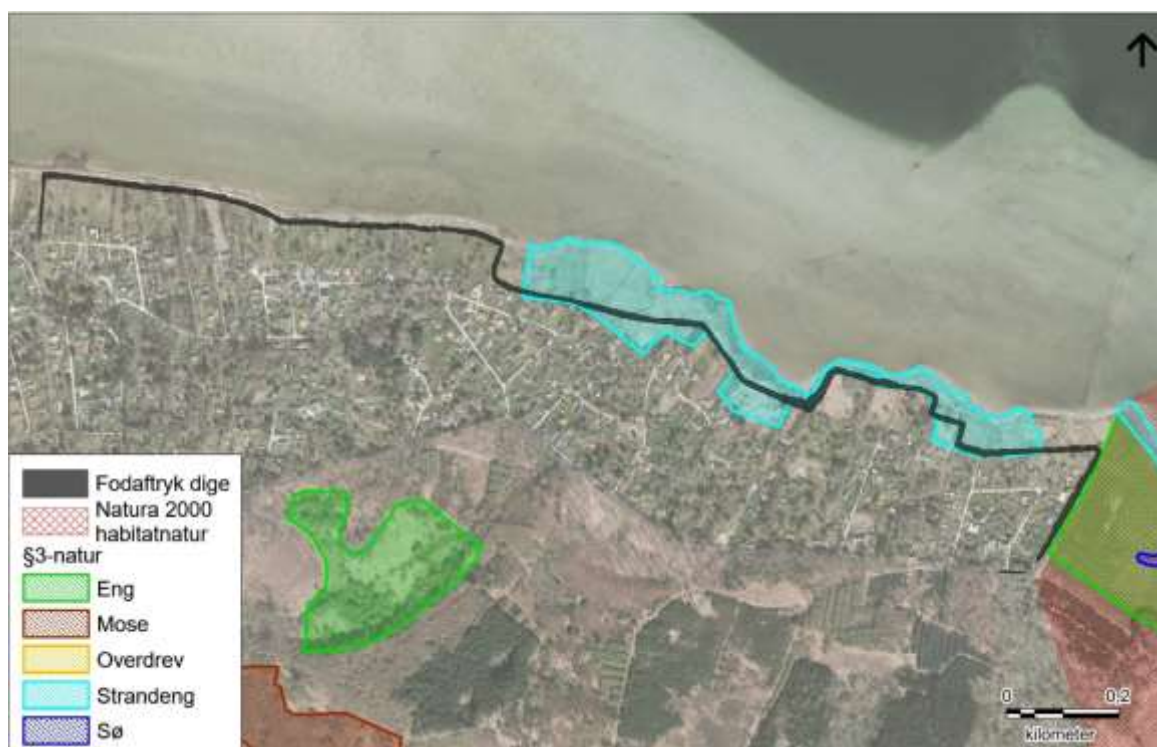
Figur 21 Beskyttede arealer. Figuren viser fodaftryk af diget sammenholdt med det udpegede Natura 2000 Habitatområde og beskyttede naturtyper i medfør af Naturbeskyttelsesloven (eng, strandeng og mose). (Fra (Miljøportalen, 2020)).
