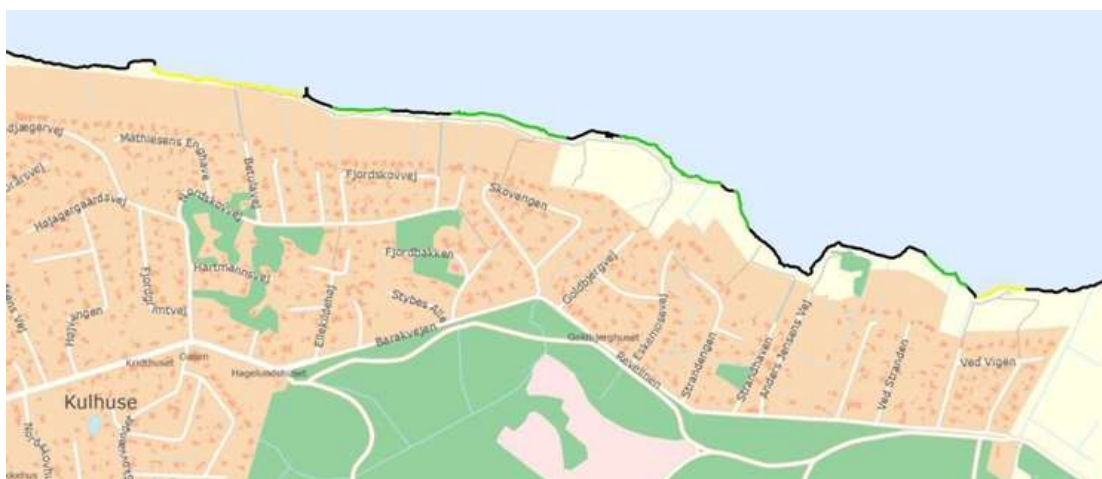
Figur 5 Kronisk erosion for projektområdet, hvor grøn linje markerer kystfremrykning, sort linje markerer lille erosionsrate og gul linje markerer moderat erosion (Frederikssund Kommune 2017).
