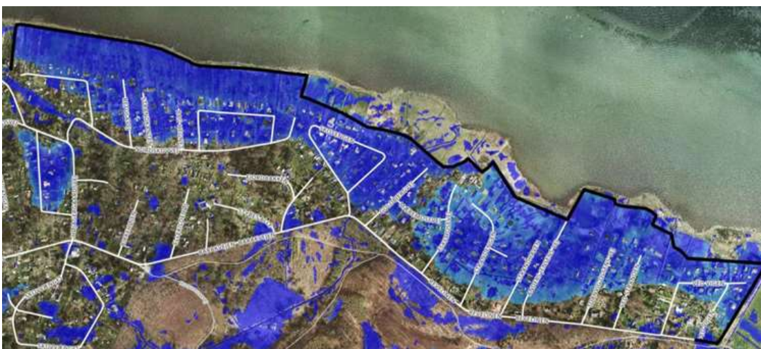
Figur 39 Overfladevand fanget på indersiden af diget uden afledning via sluser og/eller pumper. (Frederikssund Kommune 2017).
