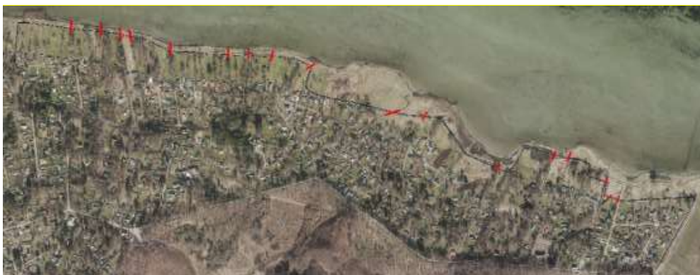
Figur 38 Oversigt over kortlagte udløb for dræn, grøfter, vandløb mv. Udløb markeret med rød streg. Udløbene fremgår ligeledes af oversigtskortet bilag 1a-1n (Frederikssund Kommune og Orbicon, 2019)
