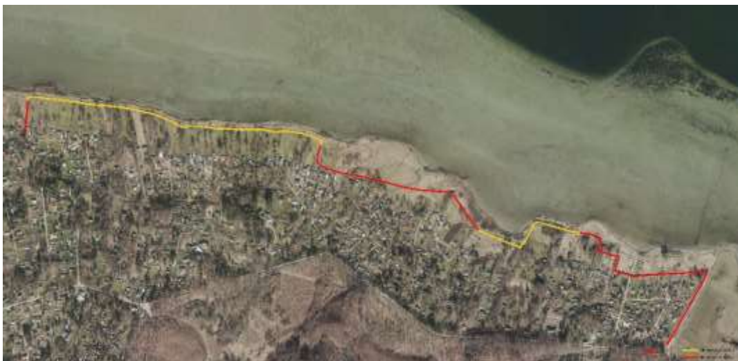
Figur 30 Oversigtskort med angivelse af sikringsniveau / digekote for de enkelte delstrækninger. Gul markerer kystnære diger med sikringsniveau 2,40 m DVR90 mens rød markerer landdiger med sikringsniveau 2,20 m DVR90 (Frederikssund Kommune og Orbicon, 2019).
