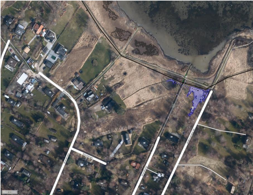
Figur 3.5: Opmagasineringsvolumen i området inden vandet begynder at stå op af husene
