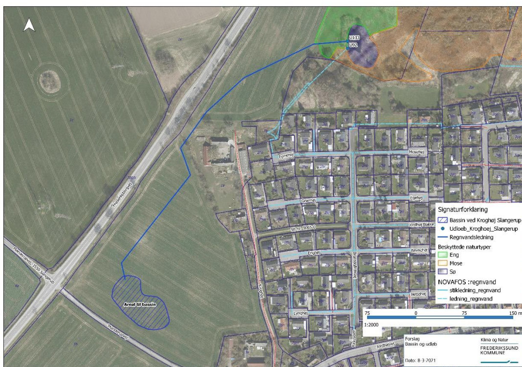
Figur 2. Med mørkeblå er vist bassin i planområdet, ny udløbsledning og nyt udløb U133. Med lyseblå er vist eksisterende regnvandsledning med udløb til samme recipient via udløb U92.
