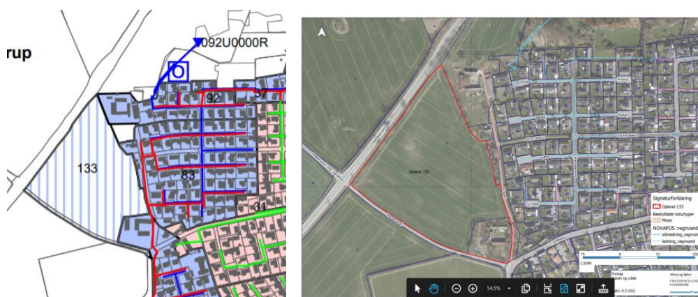
Figur 3. Udklip fra den eksisterende spildevandsplan. Det gamle opland 133, ses til venstre med blå skravering. Til højre ses det nye opland 133, med rød streg, som udvides med en del af opland 61.
