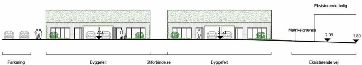
Illustration 1: Tværsnit af terrænregulering i forbindelse med etablering af den nordlige overkørsel til lokalplanområdet.
