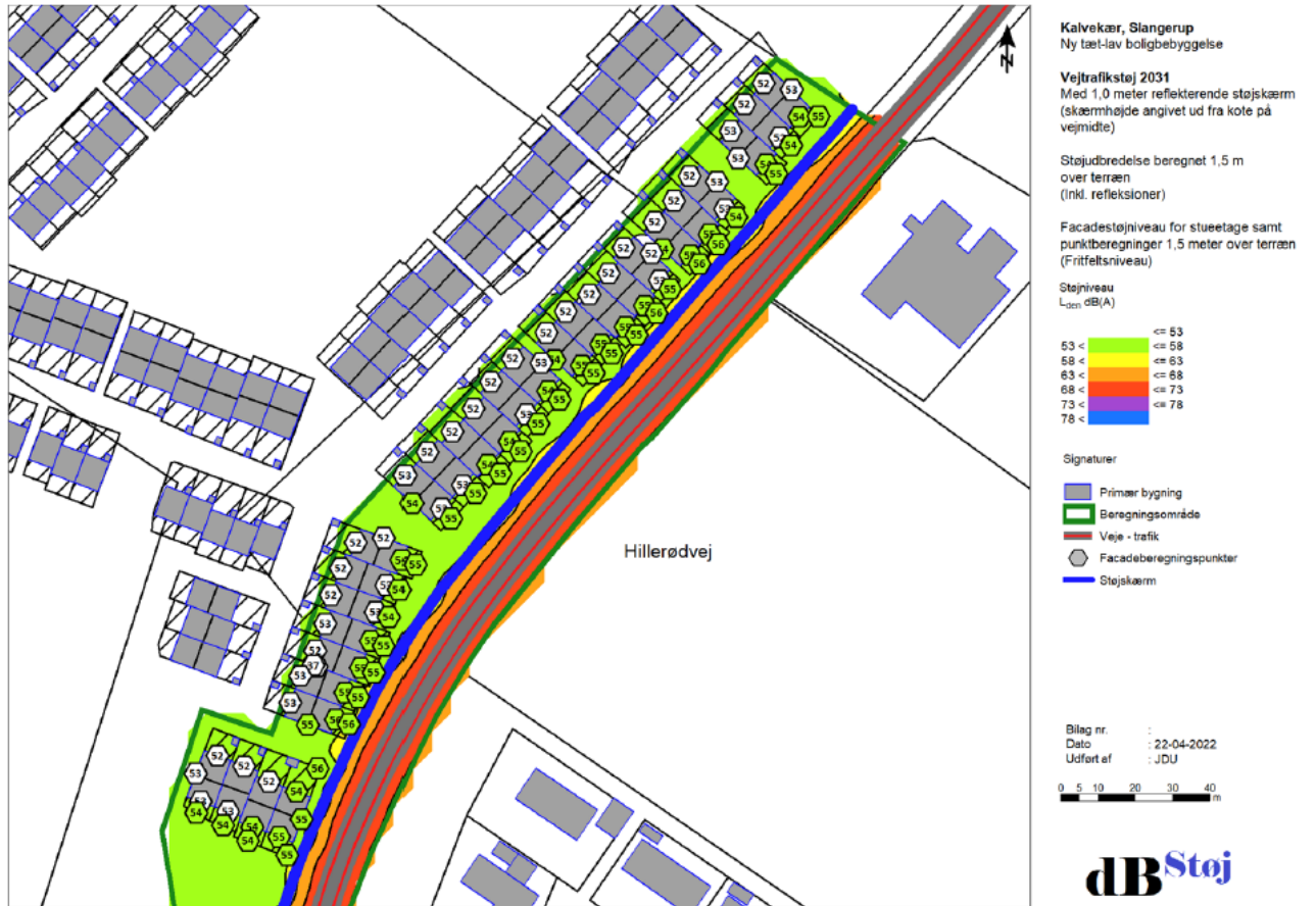
Figur 7-4 Støjudbredelseskort 1½ meter over terræn, samt facadestøjniveauer for stueplan og punktberegninger 1,5 m over terræn med en reflekterende støjskærm (inkl. refleksioner).
