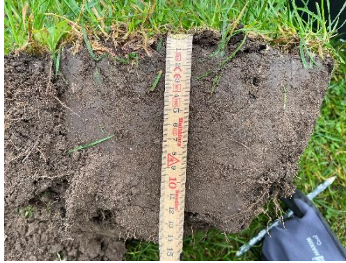
Figur 111: Ved profil 1 var der rødder til 14-15 cm dybde. Jorden var komprimeret og fast.
