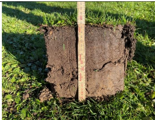
Figur 15: Profil 2 ude på fløjen i den østlige ende. Rødder til 18 cm, men tendens til komprimeret sål i 10 cm dybde. Vækstlaget er tæt lejret med tendens til anaerobe /iltfattige områder.
