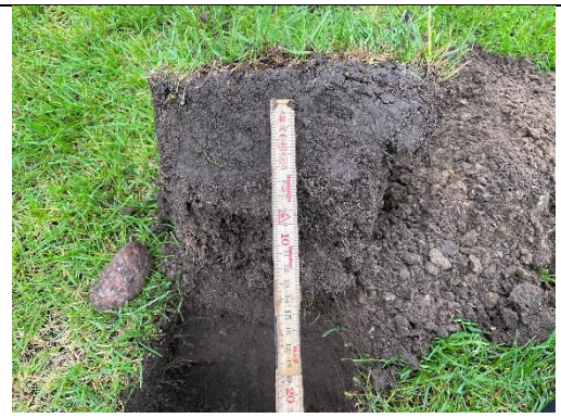
Figur 174: Ved profil 2 rødde til 15-16 cm dybde og komprimeret sål i 10 cm dybde. Der var håndstore sten i vækstlaget.
