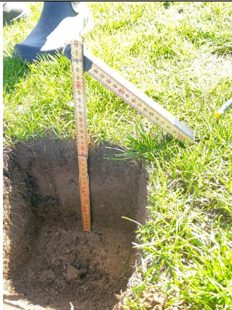
Figur 94: Profil I: Muld til 20-21 cm dybde.
