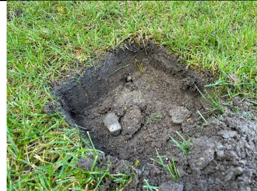
Figur 69: Muld til blot 5-6 cm dybde. Mulden er vandlidende og anaerob.
