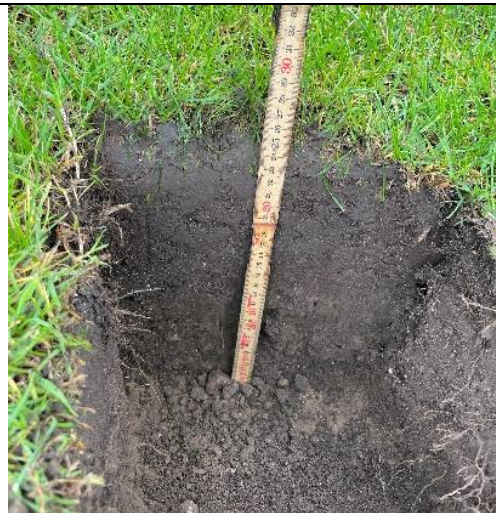
Figur 175: Profil 2. Toplaget var tæt og overfladen glitter til. Det var svært at se, om der var blevet topdresset.
