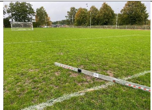
Figur 141: Dyb gennemslidning på 4 cm under retskeden.
