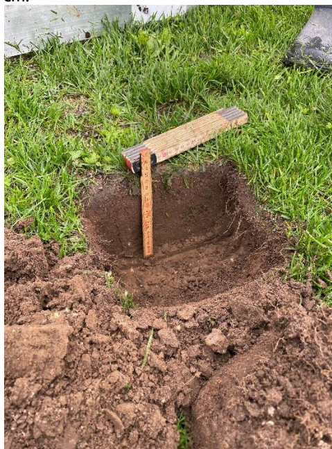
Figur 123: Ved profil 1 nogle rødder til 14 cm dybde, men fast komprimeret sål i 5-6 cm.
