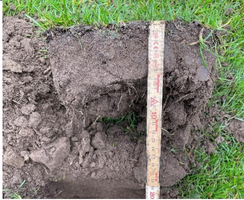
Figur 123: Ved profil 1 nogle rødder til 14 cm dybde, men fast komprimeret sål i 5-6 cm.
