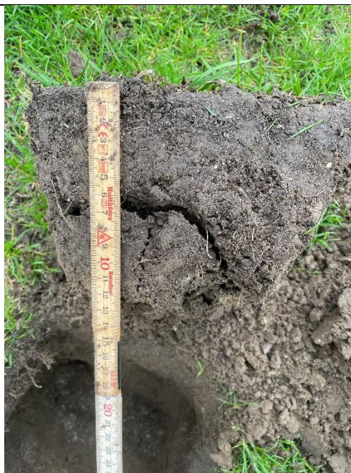
Figur 194: Ved Profil 1 var jorden stærkt komprimeret med sål i 6-7 cm dybde.
