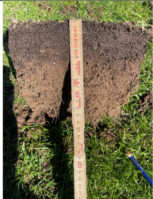
Figur 95: Rødder til 14 cm dybde. De øverste 5 cm af vækstlaget var langt mere humusholdig end resten af vækstlaget.
