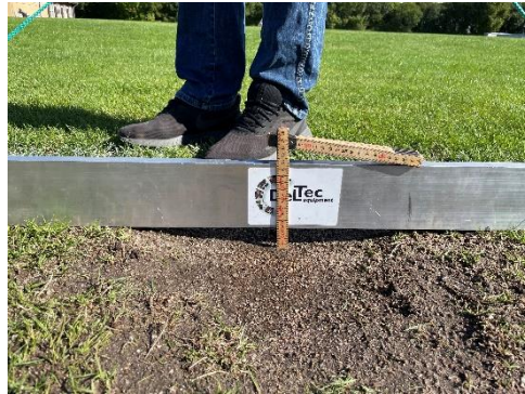
Figur 78: Et gammelt målfelt med en 3,7 cm dyb gennemslidning.
