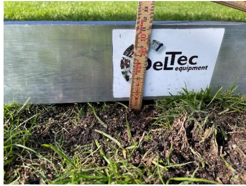
Figur 50: Spilleskader op til 1,7 cm dybe.
