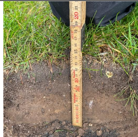
Figur 137: Meget lille muldlag på 12-13 cm over slagger, som er meget kompakte.
