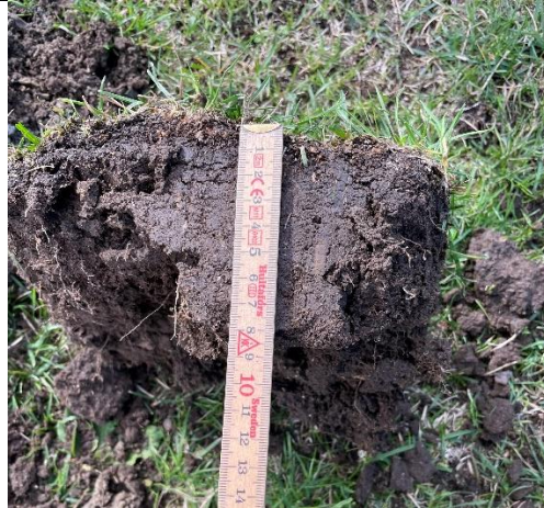
Figur 66: Rødder til 5-9 cm dybde. Jorden er stærkt komprimeret.
