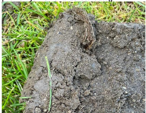
Figur 68: Rødder til 4-5 cm. Stærkt komprimeret og vandlidende jord. Læg mærke til den stålgrå farve til højre i profilen. Jorden er anaerob/iltfattig.
