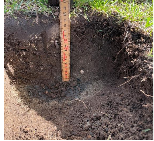
Figur 67: Vækstlag på 13-14 cm over bund af slagger, som er hårde som beton.
