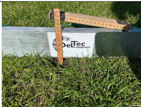
Figur 98: Der var mange små ujævnheder på op til 2 cm under 3 meter retskede. Jeg kunne dog også finde ujævnheder op til 3 cm.
