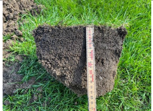
Figur 97: Rødder til ca. 15 cm dybde. De øverste 5 cm af vækstlaget var langt mere humusholdig end resten af vækstlaget.
