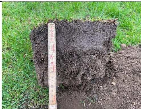
Figur 173: Ved profil 1 var der rødde til 15 cm og en komprimeret sål i 7-8 cm dybde.
