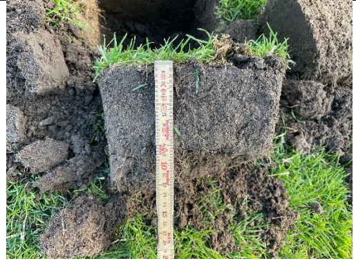
Figur 84: Rødder til 10-12 cm. Komprimeret sål i 8-10 cm dybde
