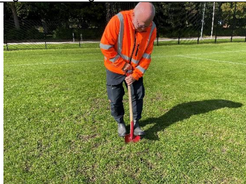
Figur 48: Profilen blev gravet ved indgangen i hjørnet ved kunstgræsbanen ud mod vejen. Overfladen var præget af mange spilleskader i en blød overflade.
