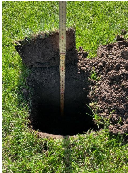
Figur 81: Dyb muld til 30 cm dybde.
