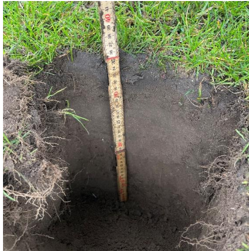
Figur 157: Profil 1. Meget dyb muld mindst til 35 cm dybde
