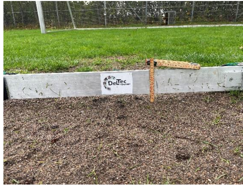
Figur 183: Et 4 cm dyb gennemslidt målfelt.
