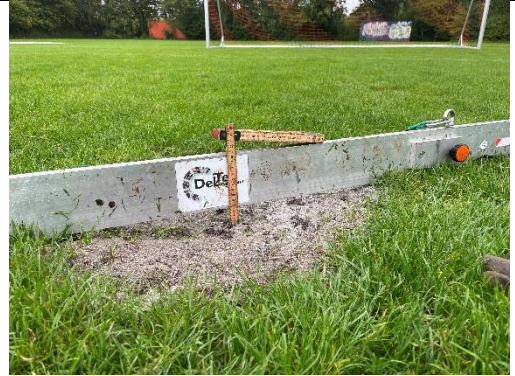
Figur 153: Straffesparkspletten var 3,7 cm dyb. Hullet var efterfyldt med sand. Her skal der muld til for at fylde hullet op. Sandet laver overfladen ustabil.
