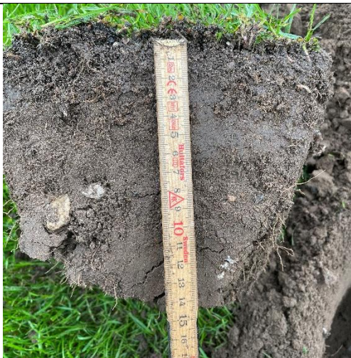
Figur 159: Profil 2. Rødder til 14 cm dybde. Der var sten i vækstlaget. Dog ikke så store, at de vil besværliggøre dybdeløsning.
