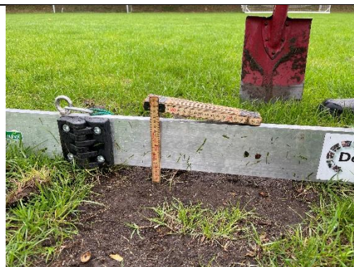
Figur 177: Ujævnheden skal fyldes med muld og eftersås.
