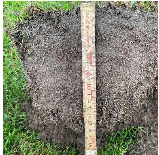
Figur 158: Rødder til 16 cm dybde.
