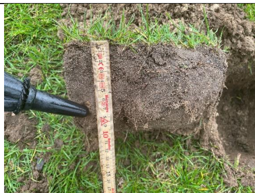
Figur 195: Også ved profil 2 var jorden stærkt komprimeret med sål i 9 cm dybde.
