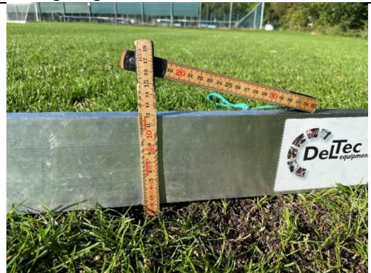
Figur 12: Spilleskaderne var maksimalt 2 cm under 3 meter retskede.
