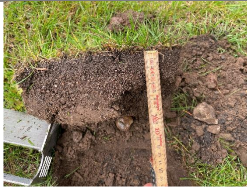
Figur 136: Rødde til 4-8 cm dybde. Fast sål i 4-8 cm dybde.
