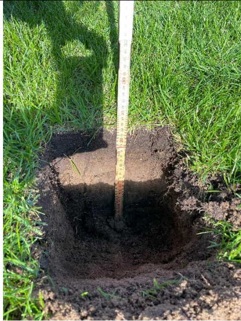
Figur 96: Muld til ca. 22 cm dybde.
