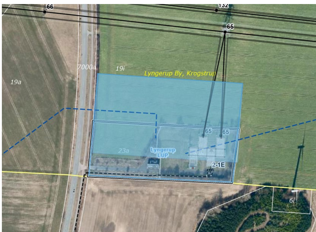
Figur 2-1. Eksisterende højspændingsstation Lyngerup. Den blå markering viser det nye stationsområde.
