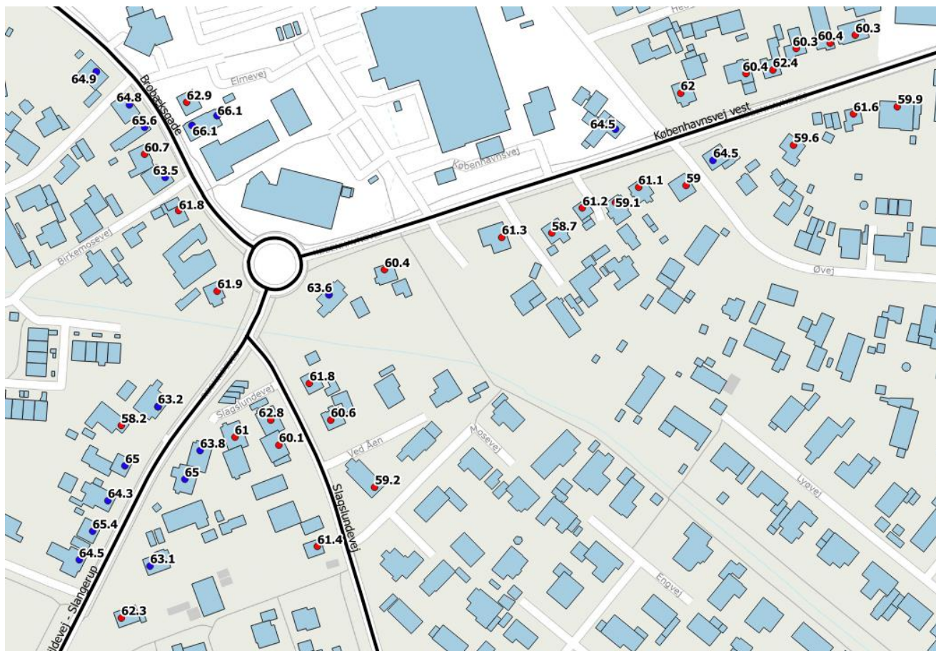
Figur 5.2: Udsnit af kortet over Slangerup med angivelse af de beregnede støjniveau pr. bolig. Støjen er beregnet på den mest støjbelastede facade.
