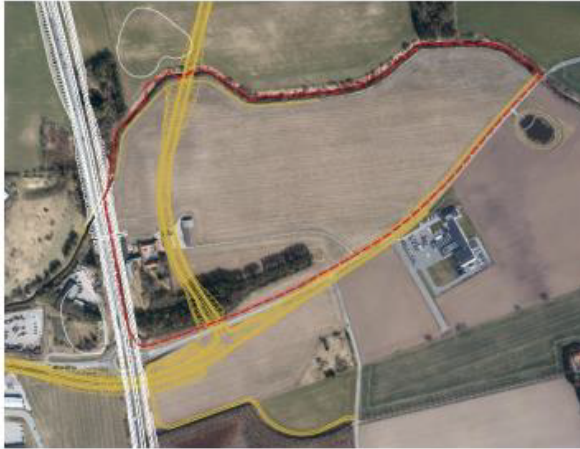
Fig. 3. Illustration af foreløbigt vejprojekt, som er vist i lokalplanforslagets redegørelse for "Planlagte trafik anlæg" (side 9). Her fremgår lokalvejen A-B gennem lokalplanområdet (gul) og en mulig fremtidig vejføring af Haldor Topsøe Park (gul), som lokalvejen A-B planlægges tilsluttet.
