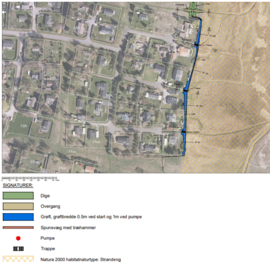
Figur 3: Oversigt over den sydlige ende af den østlige del af kystbeskyttelses anlægget, som vender mod strandengen.
