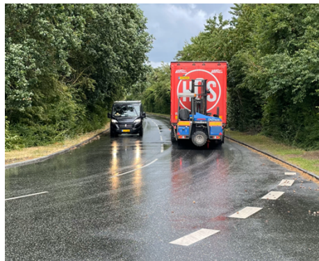
En sættevogn lægger beslag på modkørende kørespor, men har ikke oversigt til modkørende inden kurven.
